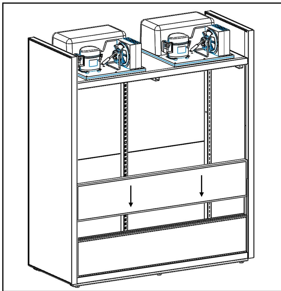
15. Поверхности контакта рамы и корпуса витрины проклеить самоклеящейся уплотнительной лентой. Завести раму в проём, провести провода рамы через отверстия в центральной стойке и панели потолка. Обеспечить зазор 2..3 мм между рамой и панелью потолка
