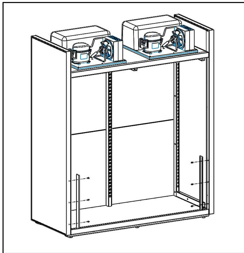
12. Приkleить уплотнитель к панели дна и завести фронтальную панель в пластиковый профиль
