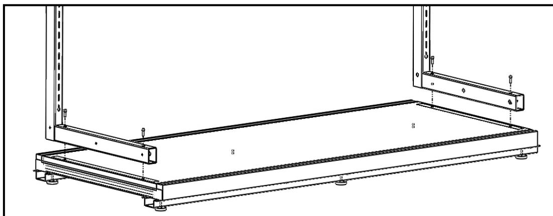
4. При克莱ить уплотнитель к панелям. Прикрепить панели спинки к стойкам при помощи болтов M6x20 с внутренним шестигранником
